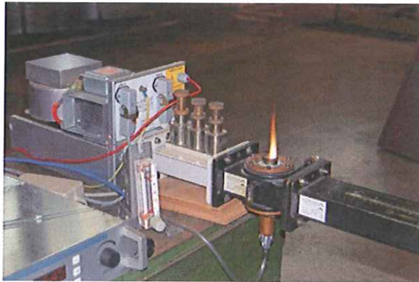
I test sono stati ripetuti sostituendo l'Argon con Azoto, e mostrano il setup sperimentale durante una sessione di studio con plasma di Azoto, e la fase su campioni di filo di acciaio.
