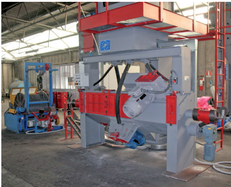
Fig. 9 - Impianto di zincatura a freddo
