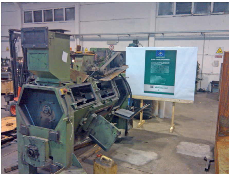
Fig. 1 - Nel corso del progetto, Metallurgica Abruzzese ha realizzato una prima granigliatrice, opportunamente modificata, per operare su filo trafilato e con utilizzo di abrasivi metallici in forma di microsferi o di piccoli cilindretti
