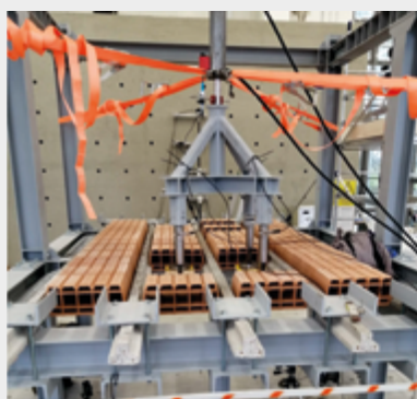
Test con carico distribuito applicato con martinetto (prova su 4 punti di carico)
