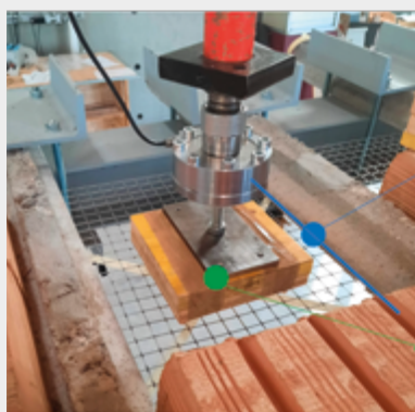
Test con carico concentrato applicato con martinetto (prova su 1 punto di carico)
