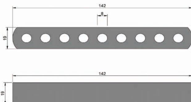
Fig. 1 - Piastra Inox e guarnizione EPDM
