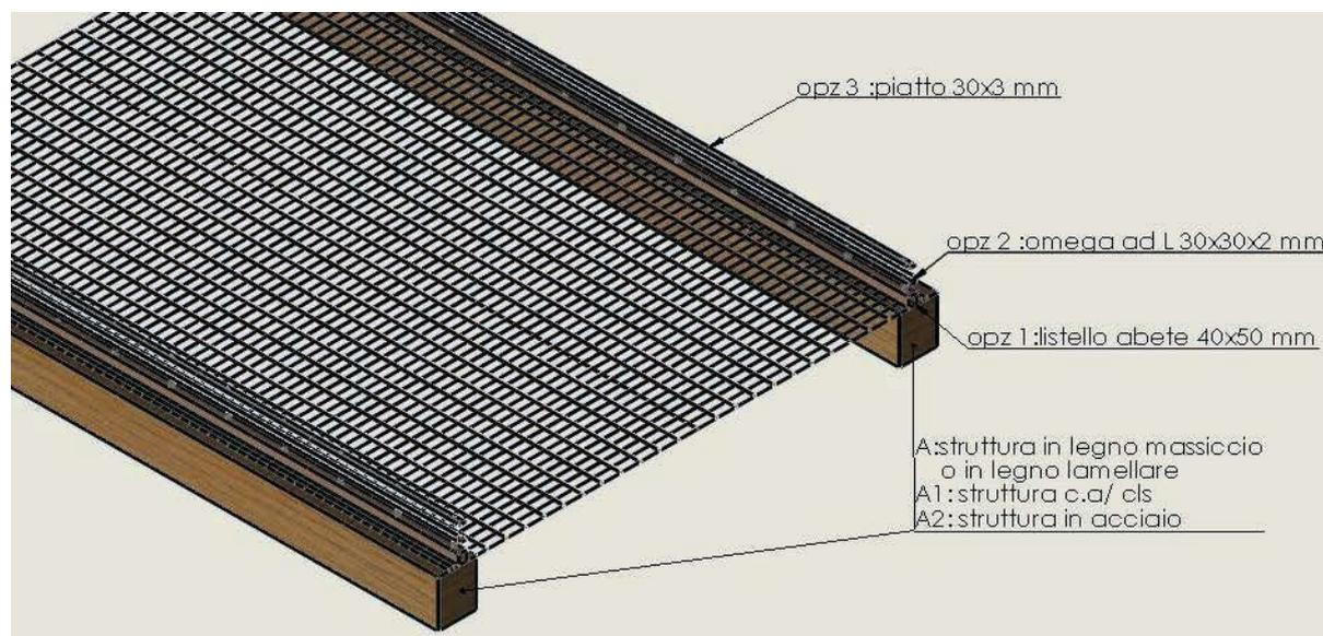
Fig. 10: schema di posa A, A1, A2
