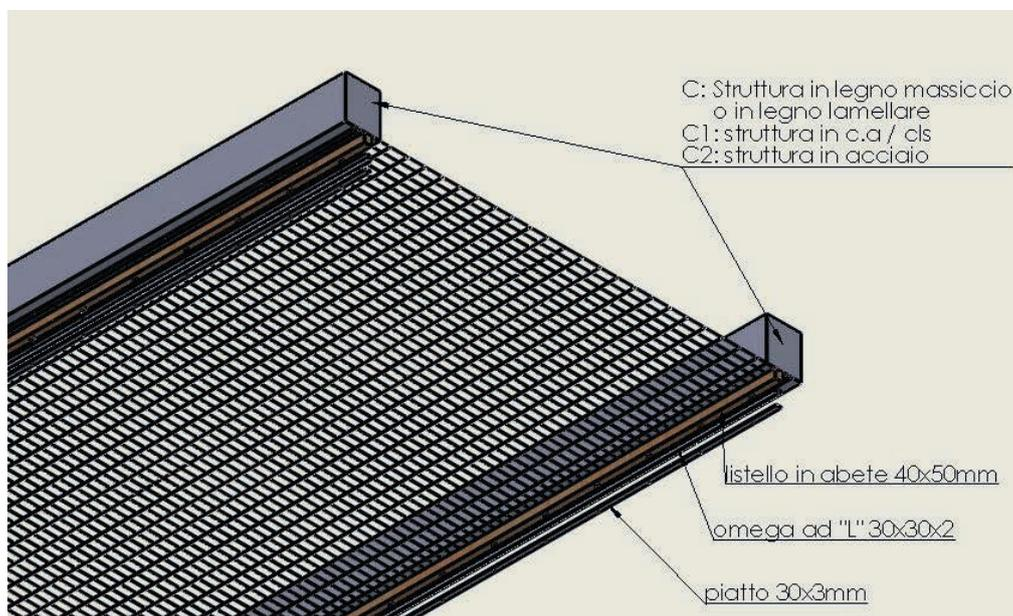
Fig. 12: schemi di posa C, C1, C2
