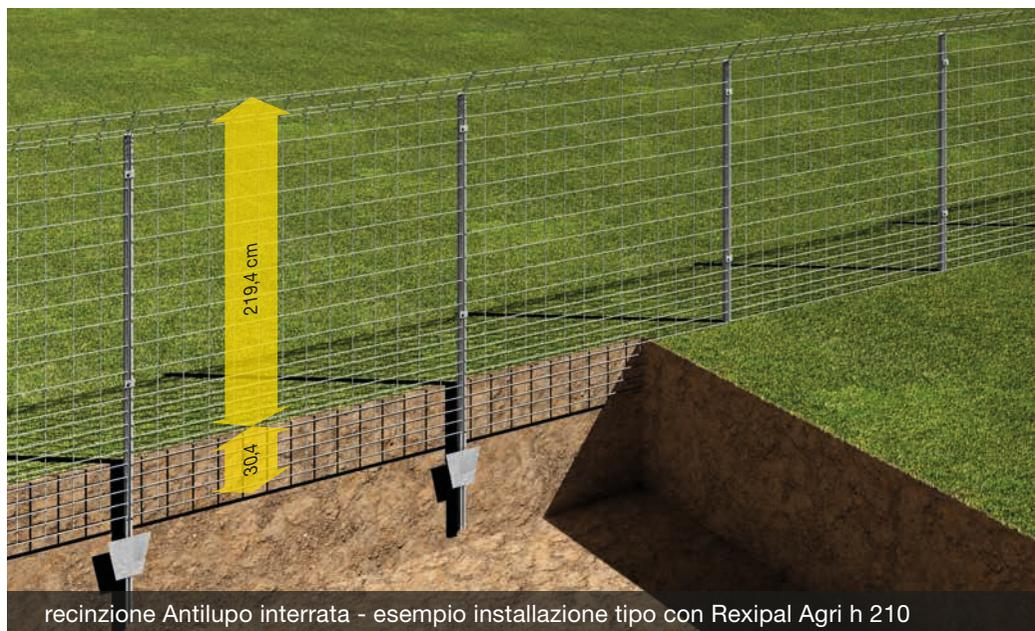
recinzione Antilupo interrata - esempio installazione tipo con Rexipal Agri h 210
